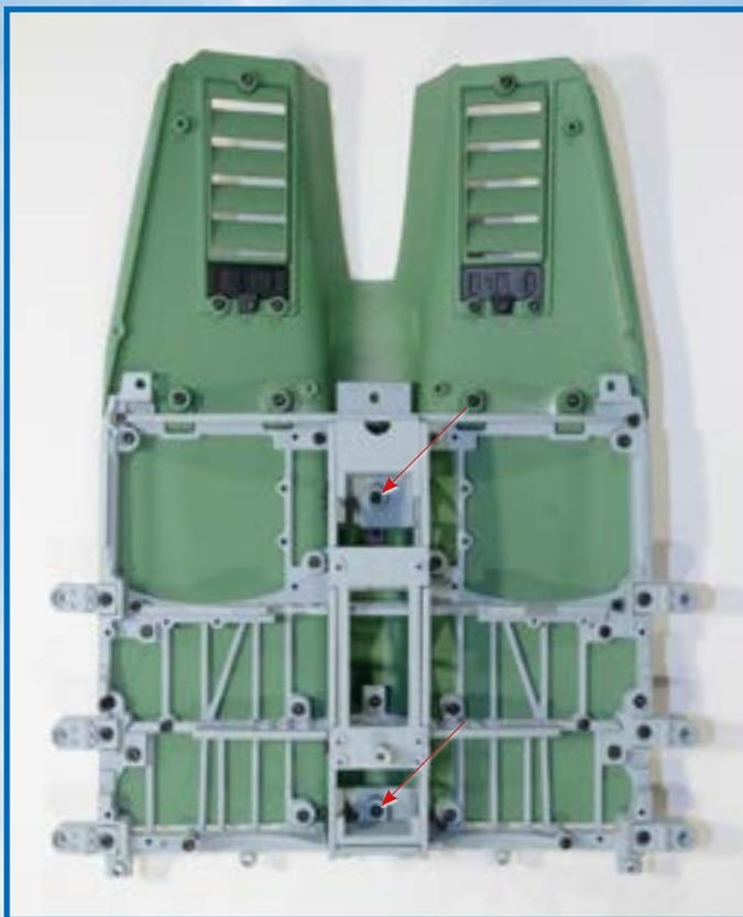
**5** Зафиксируйте короб лонжеронов двумя винтами ВМ, как показано на снимке. Очередной этап сборки завершен.
