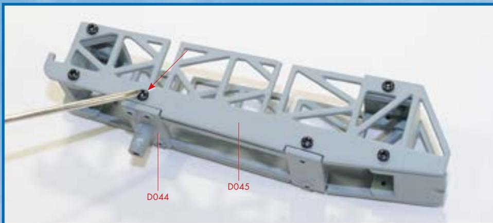
**3** Соедините полку лонжерона (D044) и правый лонжерон (D045) двумя винтами КМ, как показано на снимке.
